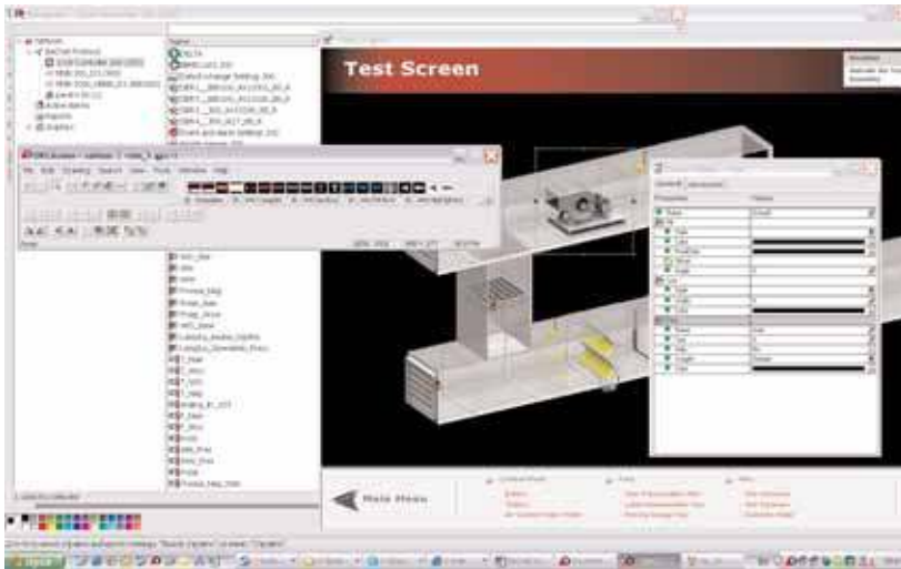
Среда разработки ORCAview и Illustrator позволит быстро создать активные мнемосхемы с 3D-графикой на основе стандартных функциональных блоков для любых BACnet-контроллеров
